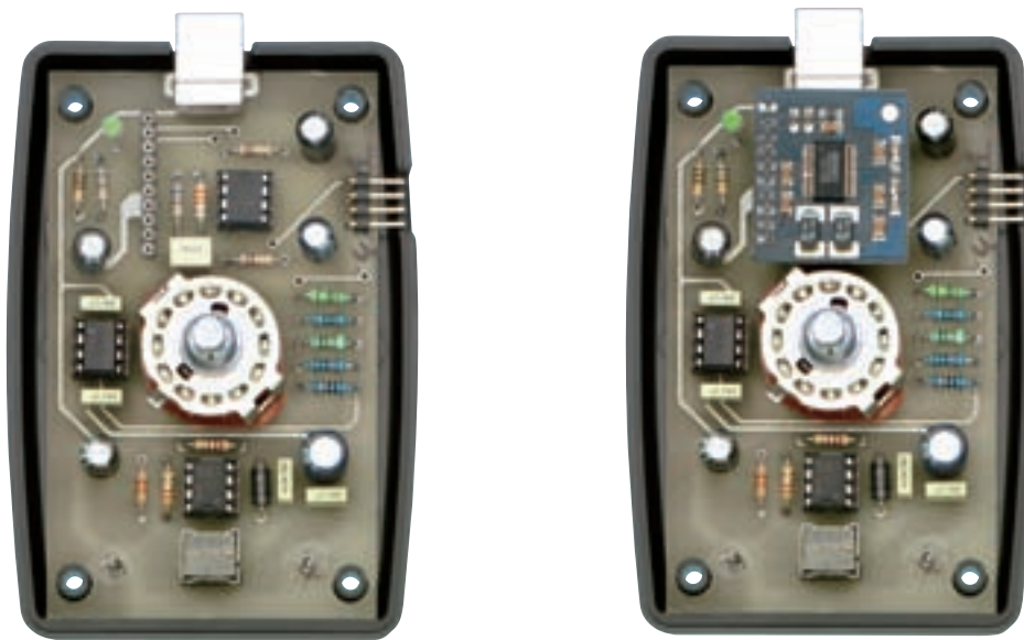
Fig.8 Une fois l'assemblage terminé, le circuit doit être placé sur le bas du meuble, en faisant coïncider les trous sur le circuit avec les butées spéciales en plastique et en prenant soin de faire sortir le connecteur CONN.3 de la fente latérale. A droite, l'assemblage est complété par la carte KM1667 en CMS.
