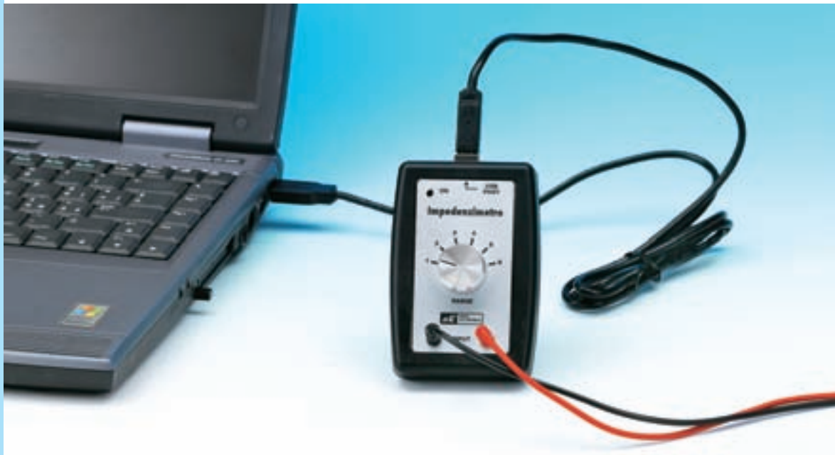
Fig.9 Sur la photo, l'interrupteur S1 est visible, ce qui vous permet de sélectionner les 5 plages différentes de l'instrument. Pour éviter les erreurs de mesure, il est nécessaire de vérifier que la position du commutateur coïncide toujours avec le nombre indiqué dans l'élément correspondant du logiciel d'exploitation.
