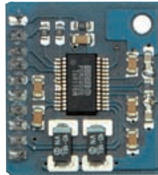
Fig. 5 Voici à quoi ressemble le circuit KM1667 contenant le convertisseur USB PCM2902, vu du côté des composants.
